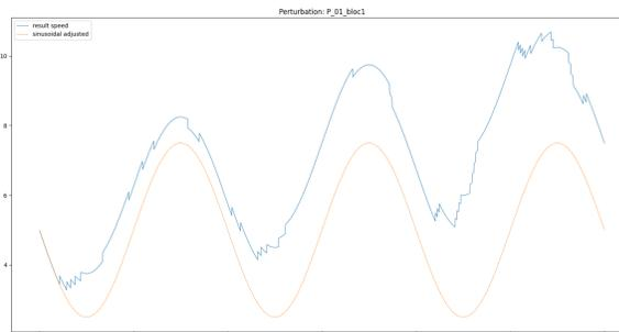
La vitesse résultante du participant augmente à chaque perturbation tout en suivant la forme sinusoidale de la perturbation de vitesse imposée.
