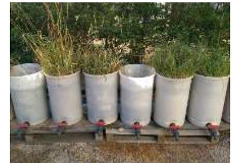
Les concentrations lixiviables (avec de l'eau désionisée) peuvent être utilisées pour tester les amendements du sol, à l'exception du plomb.
