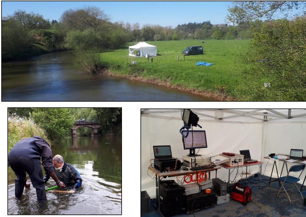
Figure A2: haut : photo du site du Bas Montmorel sur la Sélune lors d'une campagne de mesures des flux par fibre optique ; en bas à gauche : mise en place des capteurs dans les sédiments de la rivière ; en bas à droite : acquisition des mesures de température par les unités DTS (fibre optique) à l'intérieur du barnum (photo haut).
