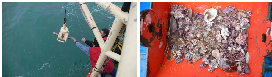
FIGURE 3.2 – Benne à sédiment Shipeck à la remontée et ouverte avec son contenu de maërl ( Lithothamnium corallioides et Phymatholithon calcareum ). N/O Côtes d'Aquitaine CNRS
