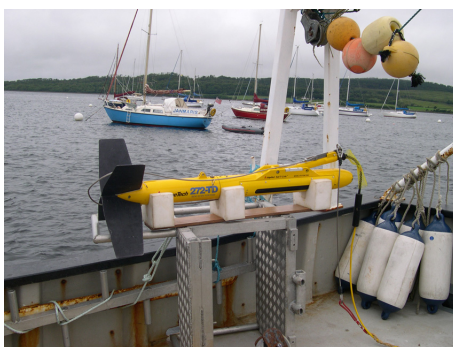
FIGURE 6.2 – Sonar acoustique EdgeTech à bord du N/O Serpula Heriot-Watt University, Edinburgh
