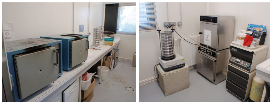
FIGURE 3.1 – Laboratoire équipé pour l'analyse granulométrique
