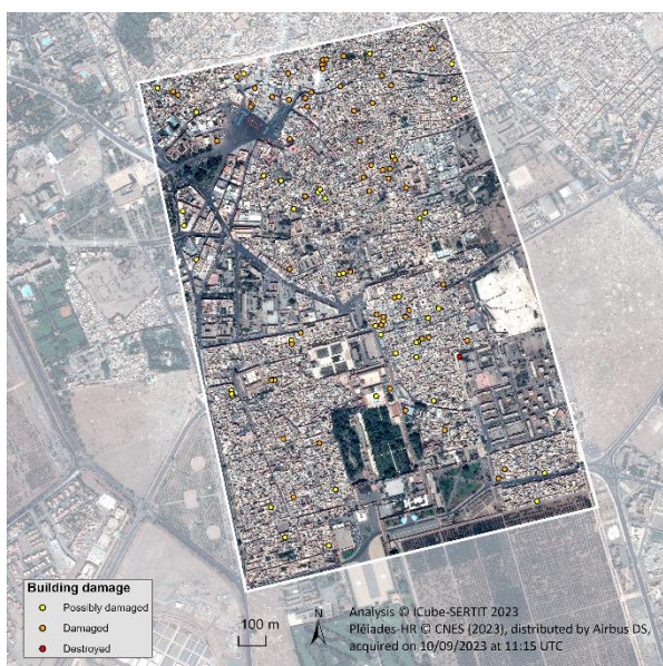
Figure 3 : Analyse des dégâts sur Marrakech à partir de l'image Pléiades-HR1B acquise le 10.09.2023
