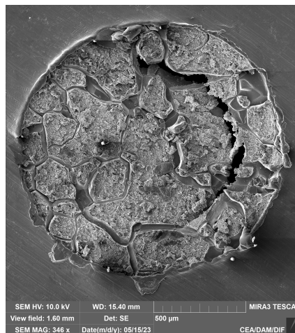
Figure 1. Image électronique d'une surface écaillée d'aluminium obtenue par choc laser
