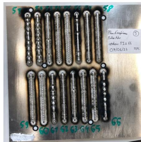
Figure 3 : Cordons fabriqués isolément sur une plaque substrat
