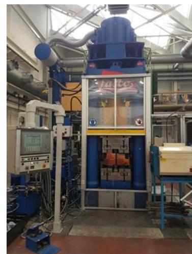
Figure 1 – La presse à vis de la plateforme Vulcain à Metz
