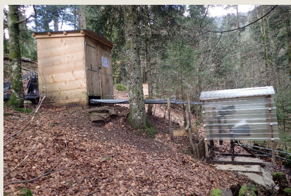
↑ Photo 3 : A la suite de la mesure de la qualité de l'eau effectuée dans la cabane, la quantité de ruissellement est évaluée dans un auget basculeur. Les particules sont ensuite piégées dans un partiteur (non figuré sur la photo).
