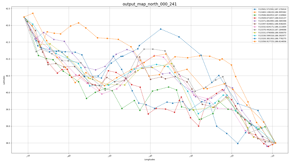
FIGURE 8 – Amelioration sur 10 iterations de la solution initiale avec d=0.5 et 200 sommets en utilisant NAMOA*-TD.
