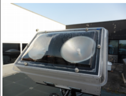
Illustration 8: Radar en bande W (95GHz). Ce radar, dont la tête peut-être orientée dans n'importe quelle direction, détecte les gouttes d'eau du brouillard et en mesure la vitesse.
