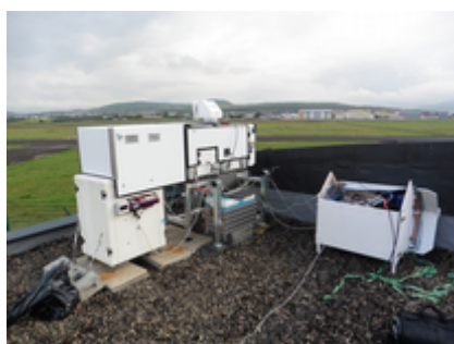
Illustration 6: Lidar Doppler scannant. D'une portée de quelques kilomètres, le lidar peut explorer le champs de vent à la résolution de 100m dans n'importe quelle direction.
