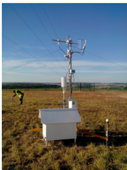
Illustration 9: Station de mesure de flux à la surface.
