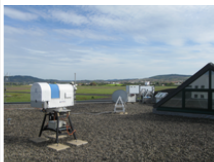
Illustration 7: Radiomètre microonde. Fonctionnant automatiquement, le radiomètre microonde délivre des profils verticaux de température et d'humidité et des contenus intégrés en eau liquide à haute résolution temporelle.
