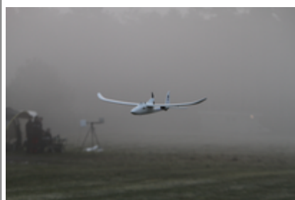
Illustration 11: Drone instrumenté en vol à basse altitude dans le brouillard. Ces petits drones peuvent être équipés de capteurs de température, d'humidité et de rayonnement, et de contenu en eau liquide.
