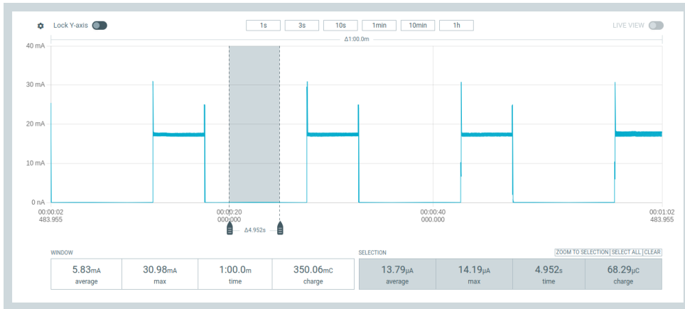
FIGURE 3 – Intensité instantanée mesurée lors de l'exécution en C++ de l'Algorithme 1 (la sélection grisée et les mesures correspondantes en bas à droite portent sur une période de sommeil profond).
