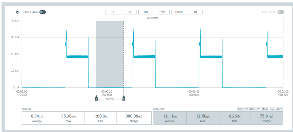
FIGURE 4 – Intensité instantanée mesurée lors de l'exécution en MicroPython de l'Algorithme 1 (la sélection grisée et les mesures correspondantes en bas à droite portent sur une période de sommeil profond).
