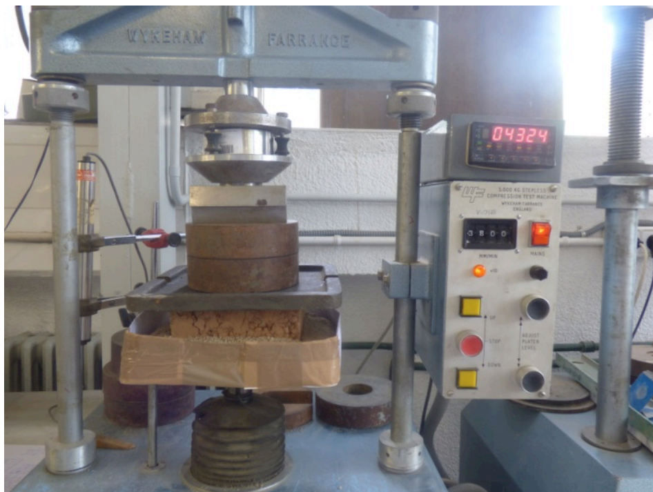
Fig. 2. Ensayo de resistencia a compresión sobre probeta prismática.
