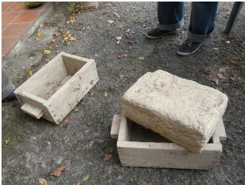
Fig.4 : Recueil de moules et autres outils anciens dans le Magnoac - © A.MARCOM
