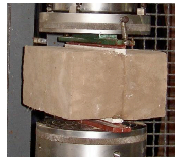
Figura 5. Modelos de esbeltez, valores de \alpha y fotos de ensayos de tracción indirecta
