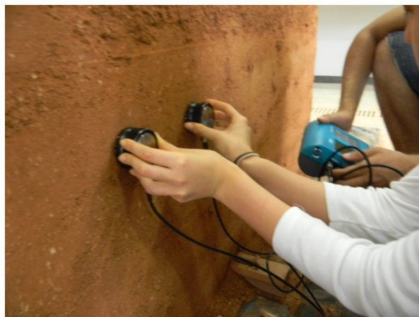
FIGURA 2: Teste de ultrasonido en el Panel 5. Fuente: PEIXOTO, 2012.
