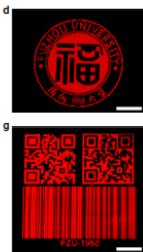
Figure 14. Image fluorescente rouge, 2D QR code et code à barre imprimé par jet d’encre avec des points quantiques
