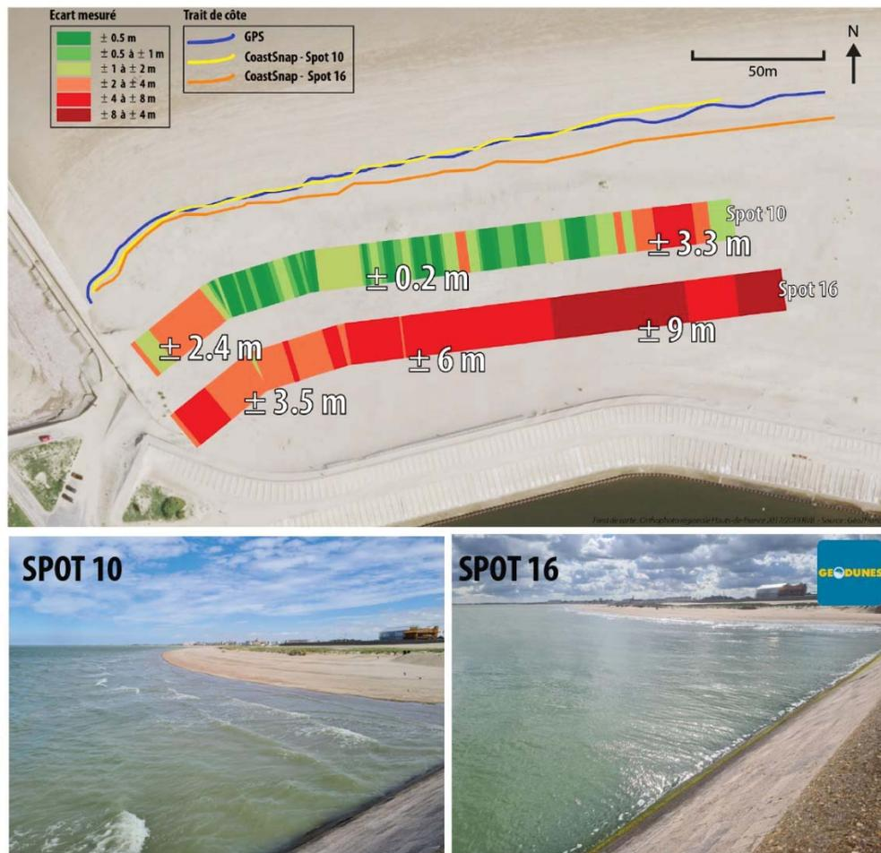
Figure 3. Exemple de comparaison entre la limite terre-mer digitalisée par CoastSnap et le relevé simultané au GNSS pour les spots 10 et 16 au niveau de la digue des Alliés.
