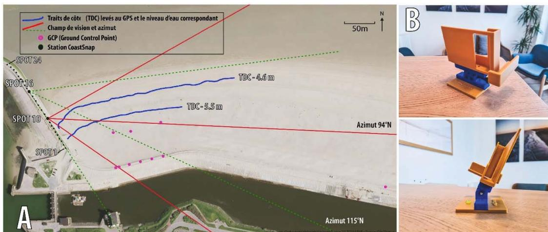
A partir des spots 10 et 16, plusieurs comparaisons ont été réalisées entre la limite terre-mer (LTM) digitalisée par *CoastSnap* et celle mesurée au GNSS (Figure 3). Les résultats montrent une différence importante de précision entre les deux localisations. Le spot 16 présente en effet des écarts supérieurs à 3 m et atteint 13 m à l'extrémité Est du linéaire concerné.
