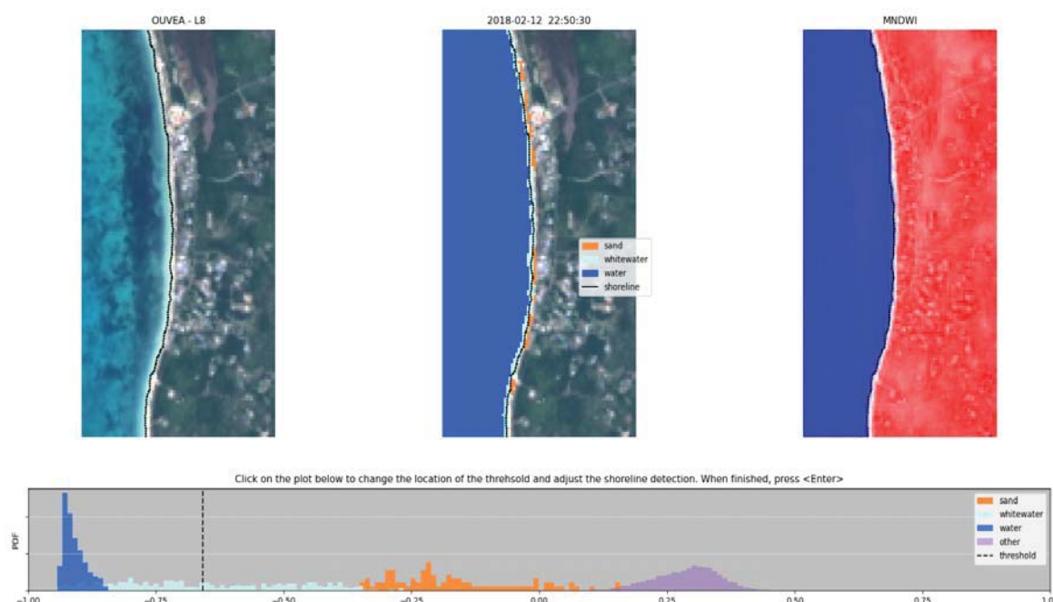
Figure 5. Capture de l'étape de validation de la position du trait de côte, CoastSat. De gauche à droite, image satellite de Landsat 8, résultat de la classification et indice MNDWI.
