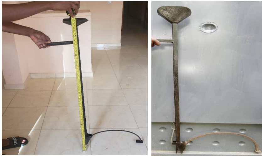
Figure 5. Travail itératif d'élaboration de la canne à semer
