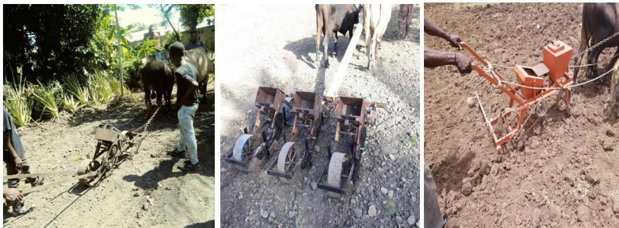
Figure 6. Travail itératif d'élaboration du semoir
