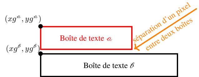
FIGURE 2 – Situations où deux boîtes sont considérées le plus proches possible
