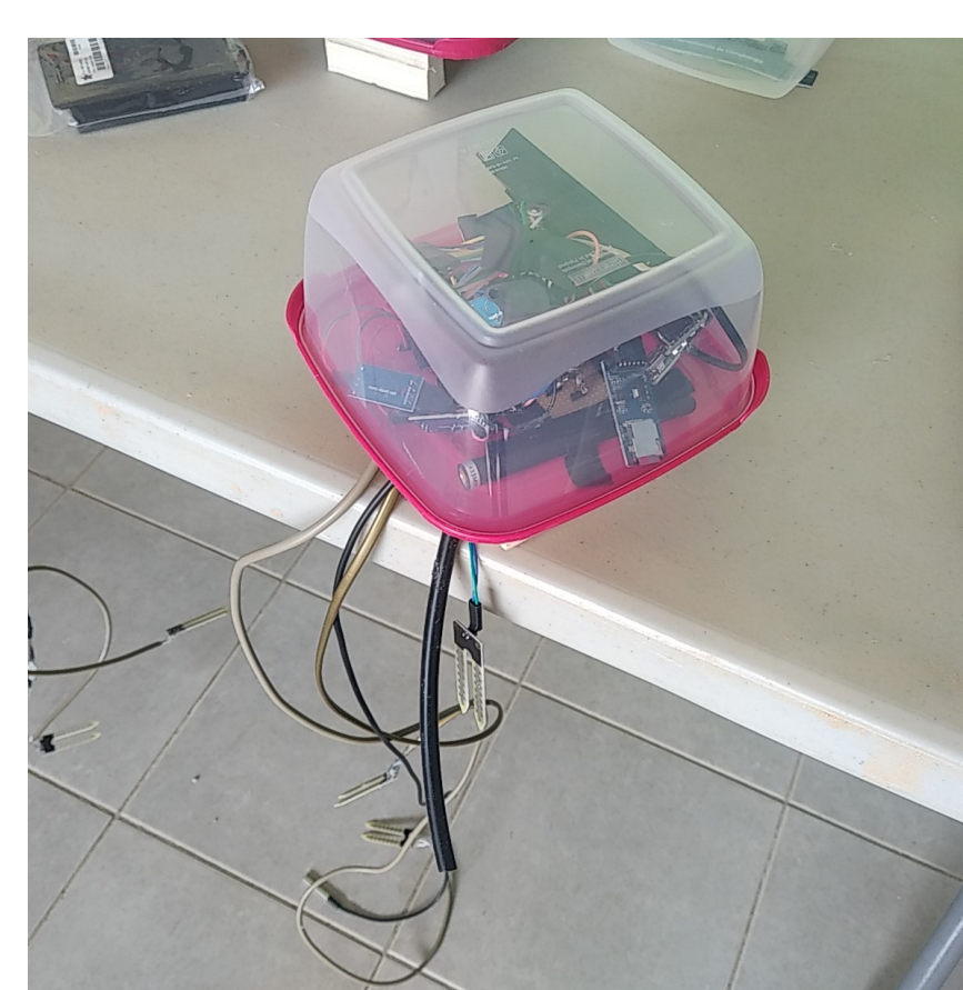
Un système monté (sans le tube de pluviomètre)
