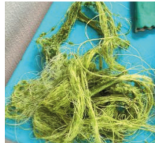
Fibres de FF après un premier passage dans la décortiqueuse mécanique
