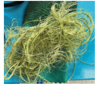
Fibres de FF après un deuxième passage dans la décortiqueuse mécanique
