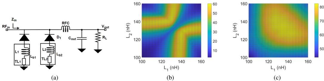
Fig. 2. Récupérateur d'énergie RF à large plage dynamique. a) Association en parallèle de deux redresseurs RF, b) rendement de l'association à  $-20$  dBm et c) rendement de l'association à  $0$  dBm en fonction de  $L_1$  et  $L_2$ .
