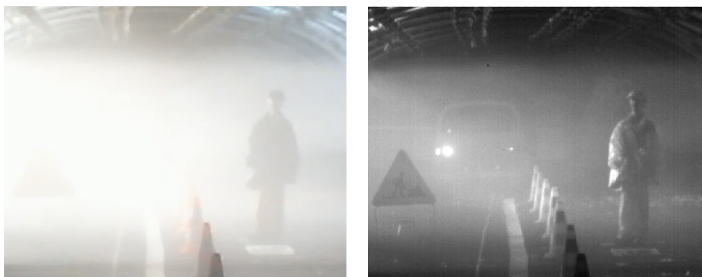
FIGURE 1 – Brouillard artificiel de jour, au Cerema, spectre visible (gauche) et SWIR (droite) ; temps exposition = 100 \mu s. Dans l'image SWIR, les détails sont nettement plus visibles : le panneau, la maquette de voiture et un plus grand nombre de cônes de chantier ainsi que le mannequin sont clairement distinguables. De plus, le brouillard est considérablement moins diffusant dans le SWIR, ce qui permet une meilleure distinction globale des objets et de l'environnement.
