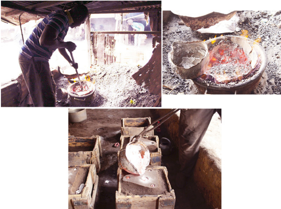
Figure 5. Coulage d'une marmite. (© Magueye Thioub, 2018)
