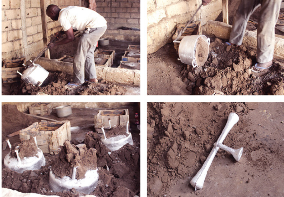
Figure 6. Démoulage d'une marmite de 30kg. (© Magueye Thioub, 2018)
