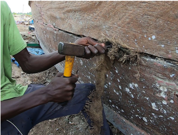
Figure 6. Photo montrant l'insertion du tissu dans la couture entre les planches avec un fer à calfat en Casamance. (© Marc Guyon, Inrap et Laure Meunier)
