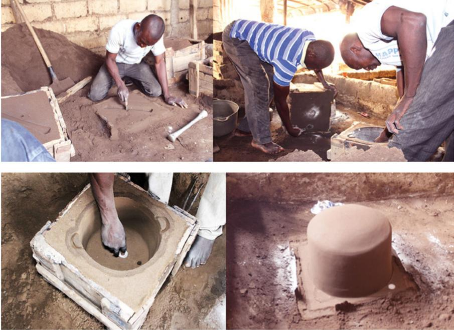
Figure 3. Une étape du moulage, où le fondeur supprime les irrégularités par lissage. (© Magueye Thioub, 2018)
