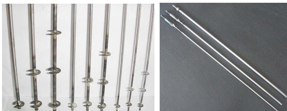
Figure 3. Modèles de pieux avec et sans hélices
