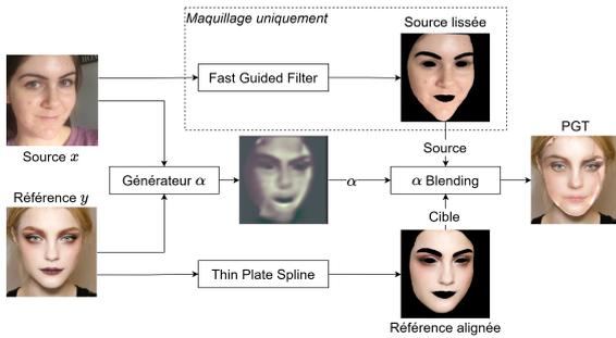
FIGURE 3 – La pseudo-vérité terrain (PGT) est le résultat d'un  $\alpha$  blending [36] entre la référence et la source (lissée pour le processus de maquillage). Le blending est calculé à partir d'un masque déterminé pour chaque pixel du visage. Ce masque est obtenu à l'aide d'un réseau auto-supervisé appelé générateur  $\alpha$ .
