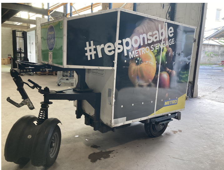
Figure 2 - Remorque à trois roues motorisée
