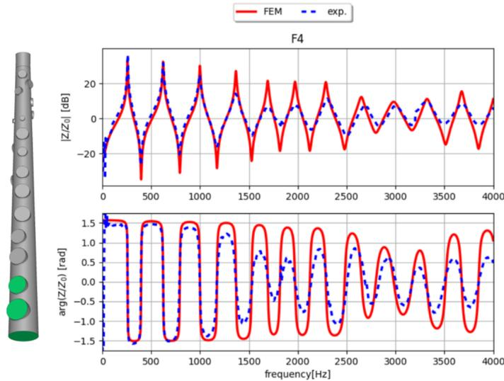
FIGURE 6 – Comparaison de l'impédance d'entrée entre la simulation et les mesures expérimentales pour le doigté F4. Sur la gauche sont représentés les doigtés correspondant (en vert les cheminées ouvertes), sur la droite sont affichés l'amplitude et la phase
