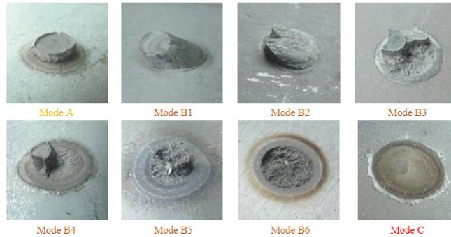
FIGURE 4 – Modes de rupture des PSR [1]
