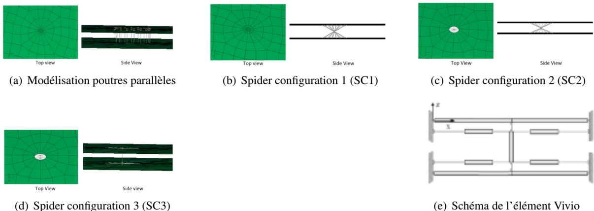
FIGURE 7 – Différentes modélisations utilisant plusieurs poutres [2],[6]
