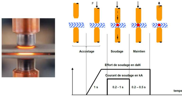
FIGURE 2 – Principe du soudage de points par résistance [1]
