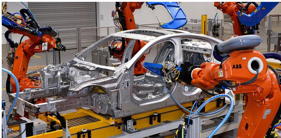
FIGURE 1 – Robots utilisés pour l'assemblage des caisses de voiture [12]
