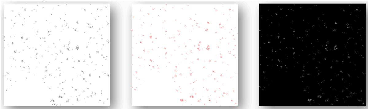
FIGURE 2 – Exemple de micrographie binaire correspondant à une porosité de surface (à gauche); micrographie après seuillage (au milieu); modèle synthétique après calcul de la fraction surfacique de vide : 1,5% et du rayon de pore moyen : 0.01mm (à droite).
