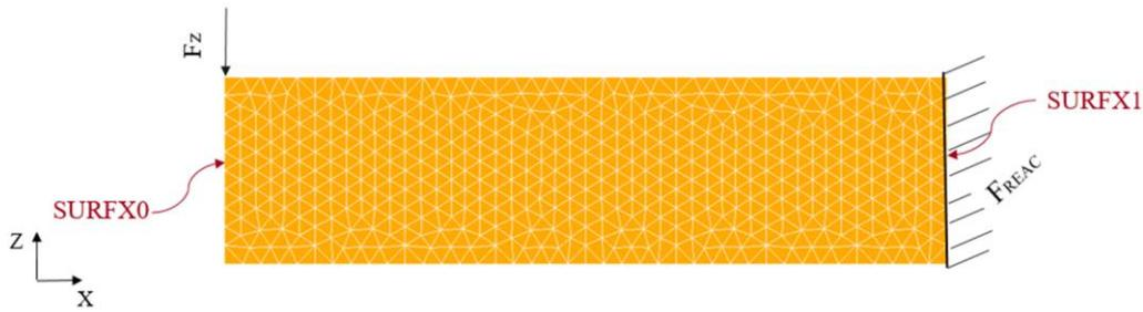
Figure 7 – Représentation de la macrostructure considérée avec les conditions limites appliquées et le chargement dans le plan XOZ
