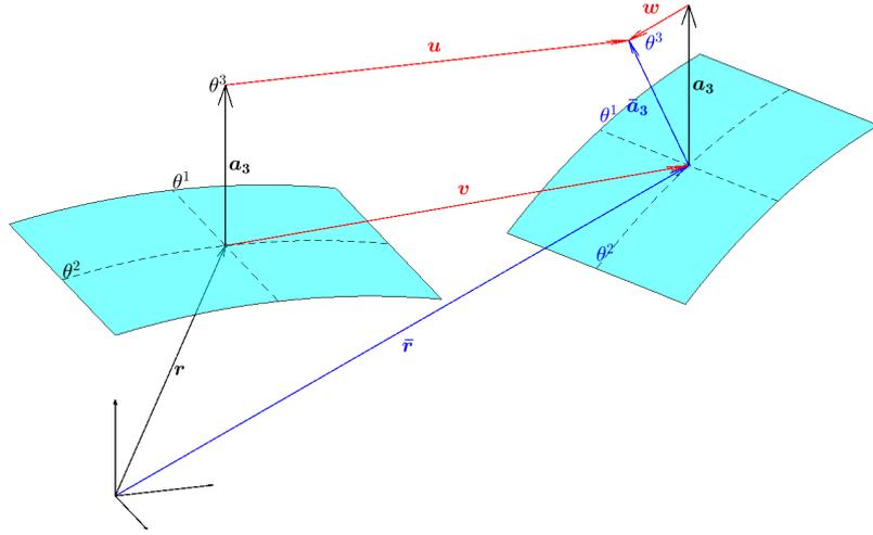
FIGURE 1 – Géométrie et cinématique de l'élément coque
