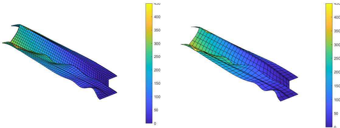
FIGURE 9 – Vues de dessous des configurations aux points critiques (l'encastrement est à l'extrémité droite des poutres en I). Figure de gauche : référence avec des éléments HEX20 et la méthode MAN (HEX20-ANM-Reference) en  $\lambda = 0.84$ . Figure de droite : éléments 3D-coques avec méthode pré-traitement des vecteurs directeurs et méthode Riks (7p-shell-PRE-Riks), en  $\lambda = 0.86$ .
