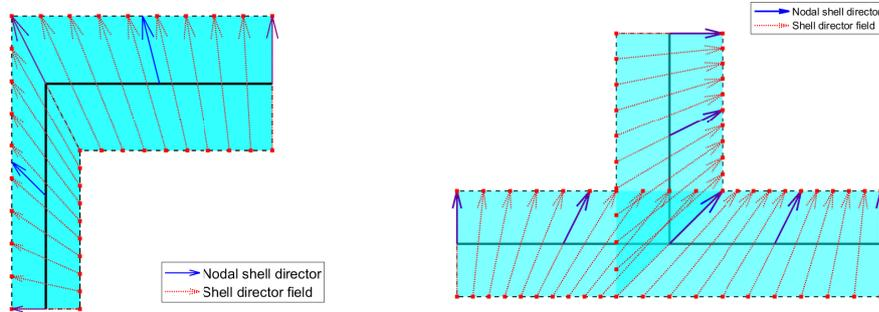
FIGURE 4 – Vecteurs directeurs nodaux  $\mathbf{a}_3$  (en bleu) pour les éléments 3D-coques à l'interface âme-semelle et vecteurs directeurs obtenus via les fonctions de forme quadratiques des éléments coques (en rouge). Cas des profilés minces en L et en T.
