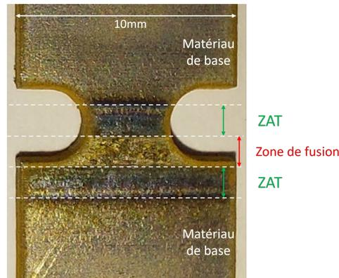
FIGURE 4 – Les différentes zones de la soudure
