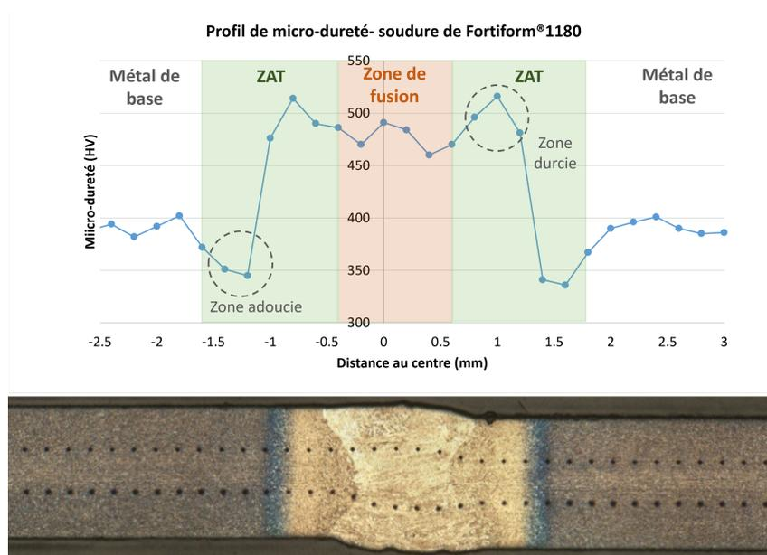
FIGURE 1 – Mesures de micro-duretés dans la soudure
