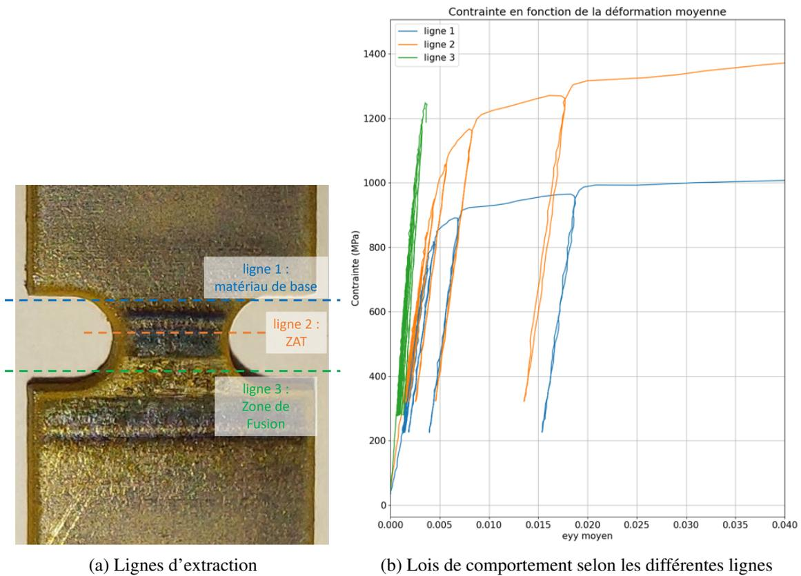
FIGURE 5 – Lois de comportement des différentes zones de la soudure - éprouvettes à encoches larges avec soudure
