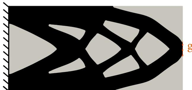
FIGURE 4 – Géométrie optimale de  $\Omega \subset D$  avec CutFEM pour  $h = \frac{1}{100}$  m et  $k = 1$ , compliance finale 0.246 kJ, volume final 1.145 m<sup>2</sup>
