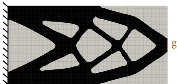
FIGURE 3 – Géométrie optimale de  $\Omega \subset D$  avec CutFEM pour  $h = \frac{1}{30}$  m et  $k = 1$ , compliance finale 0.172 kJ, volume final 0.829 m<sup>2</sup>
