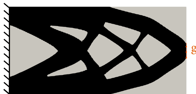
FIGURE 6 – Géométrie optimale de \Omega \subset D avec la méthode du matériau fictif pour h = \frac{1}{100} m, compliance finale 0.255 kJ, volume final 1.211 m 2
