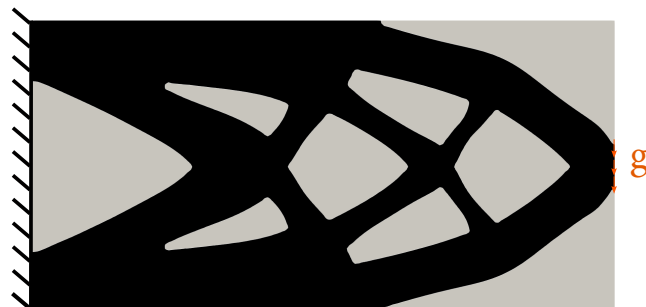
FIGURE 4 – Géométrie optimale de \Omega \subset D avec CutFEM pour h = \frac{1}{100} m et k = 1 , compliance finale 0.246 kJ, volume final 1.145 m 2
