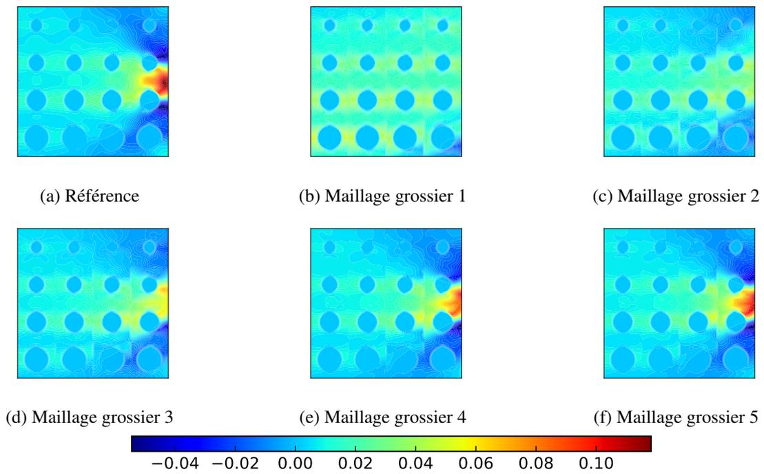
FIGURE 4 – La déformation  $\varepsilon_{11}$  régularisée suivie par une relocalisation
