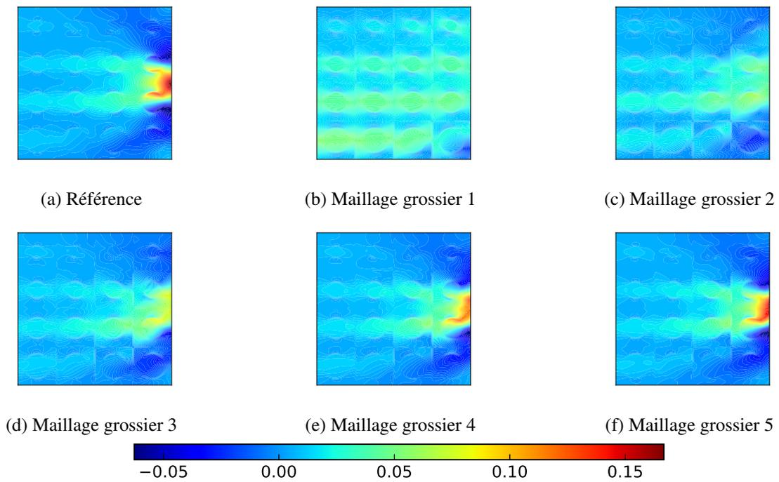
FIGURE 5 – La contrainte  $\sigma_{11}$  régularisée suivie par une relocalisation
