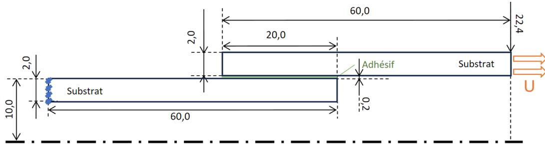
FIGURE 1 – Représentation schématique de deux tubes concentriques collés sollicités en traction.
