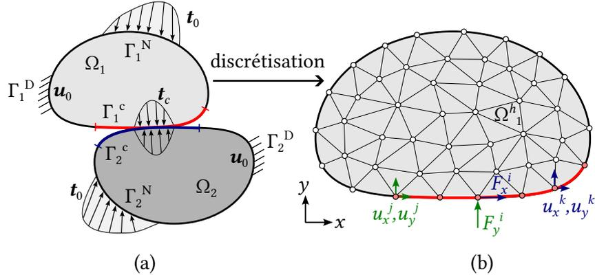
FIGURE 1 – Description du problème de contact avec conditions aux limites : (a) cas continu, (b) représentation discrétisée  $\Omega_1^h$  du corps  $\Omega_1$ , illustrant les forces surfaciques et le déplacement résultant.
