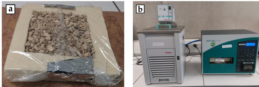
**FIGURE 3.** Dispositif de mesure de la conductivité thermique des granulats en vrac.
