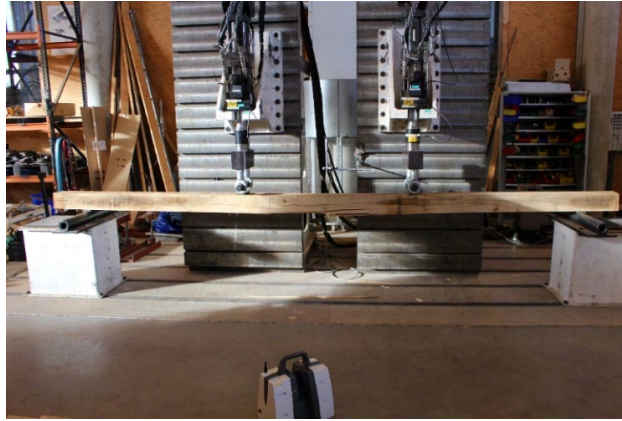
FIGURE 1. Montage de flexion 4 points (poutre chêne de 5m ; section 150x150 mm 2 )
