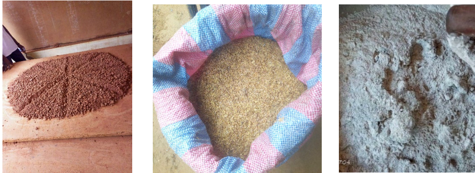
FIGURE 2. (a) Sol latéritique (b) Balles de riz (c) Cendre de balles de riz
