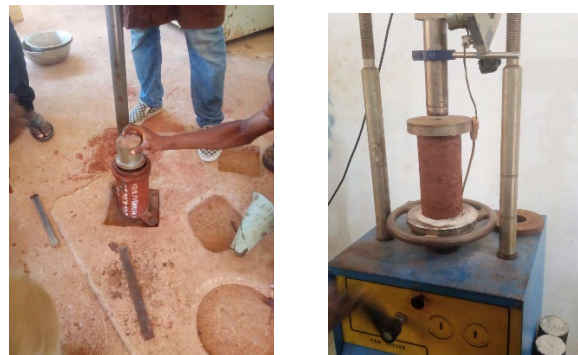
FIGURE 3. (a) Confection des Eprouvette (b) Eprouvette sous compression
