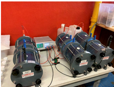
FIGURE 1. Dispositif utilisé pour la détermination du coefficient de diffusion apparent D_{\text{rcm}}
