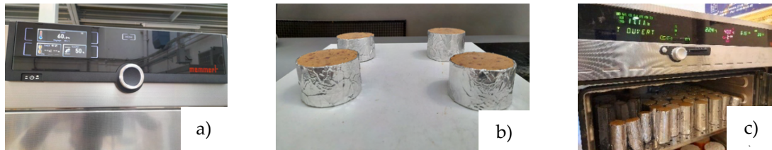
Figure 2 : Dispositif expérimental pour la carbonatation : a) étuve, b) échantillon avec une face exposé, c) enceinte de carbonatation
