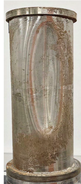
FIGURE 11 : Déformée du cylindre pour l'essai E2_{fc=0,48}
