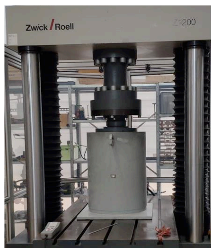
FIGURE 6 : Banc d'essai fermé avec la traverse de la presse mise en contact
