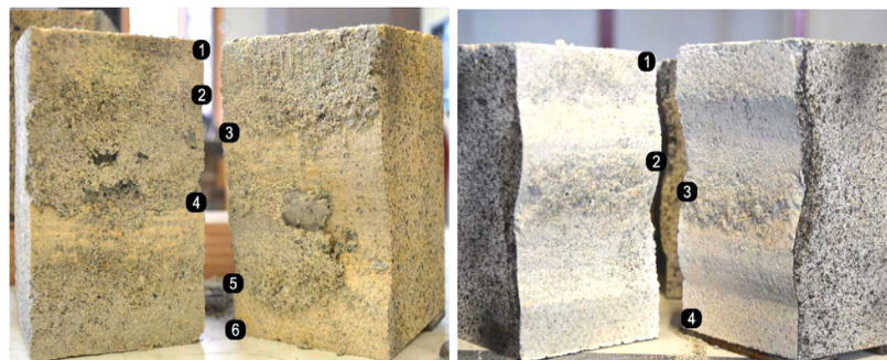
FIGURE 11. Fissuration interfaciale observée lors du test de cisaillement. A gauche éprouvette placée « à l'envers », à droite éprouvette placée « à l'endroit ».
