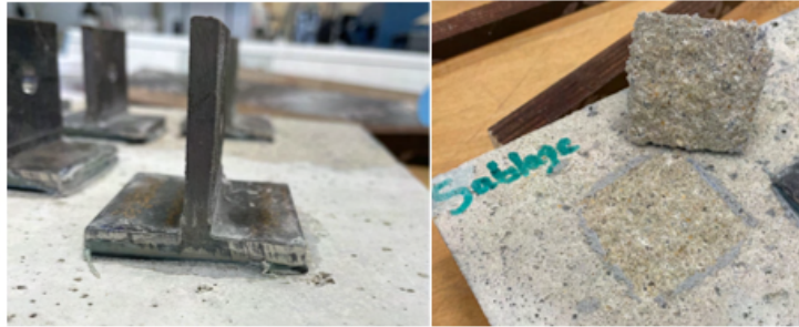
FIGURE 2. Essai d'arrachement avant et après la rupture
