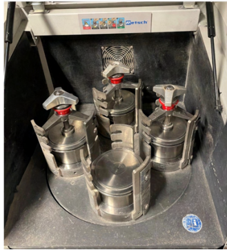
FIGURE 1. Broyeur planétaire à bille – 4 jarres
