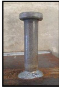
FIGURE 2. Goujon à tête soudé
