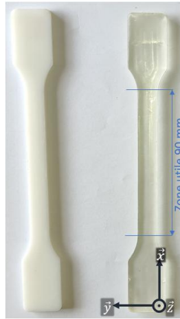
Fig. 1. Photo d'éprouvettes de traction de résine pure, de deux systèmes différents
