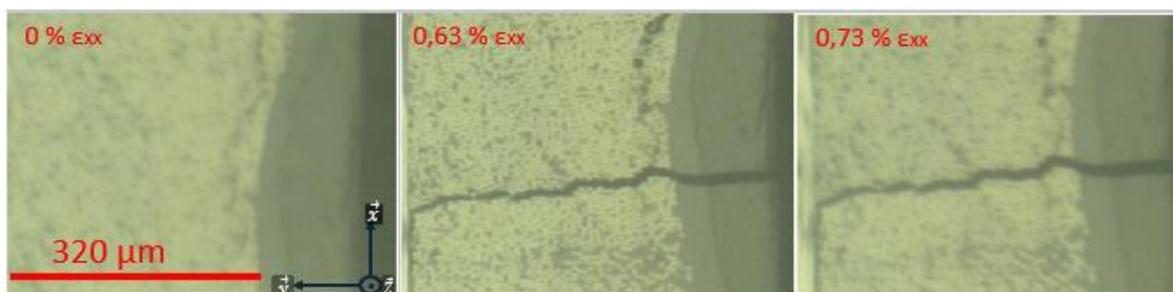
Fig. 6 Formation d'une fissure transverse dans le composite et propagation dans le revêtement au cours d'un essai de traction à  $-130^{\circ}\text{C}$
