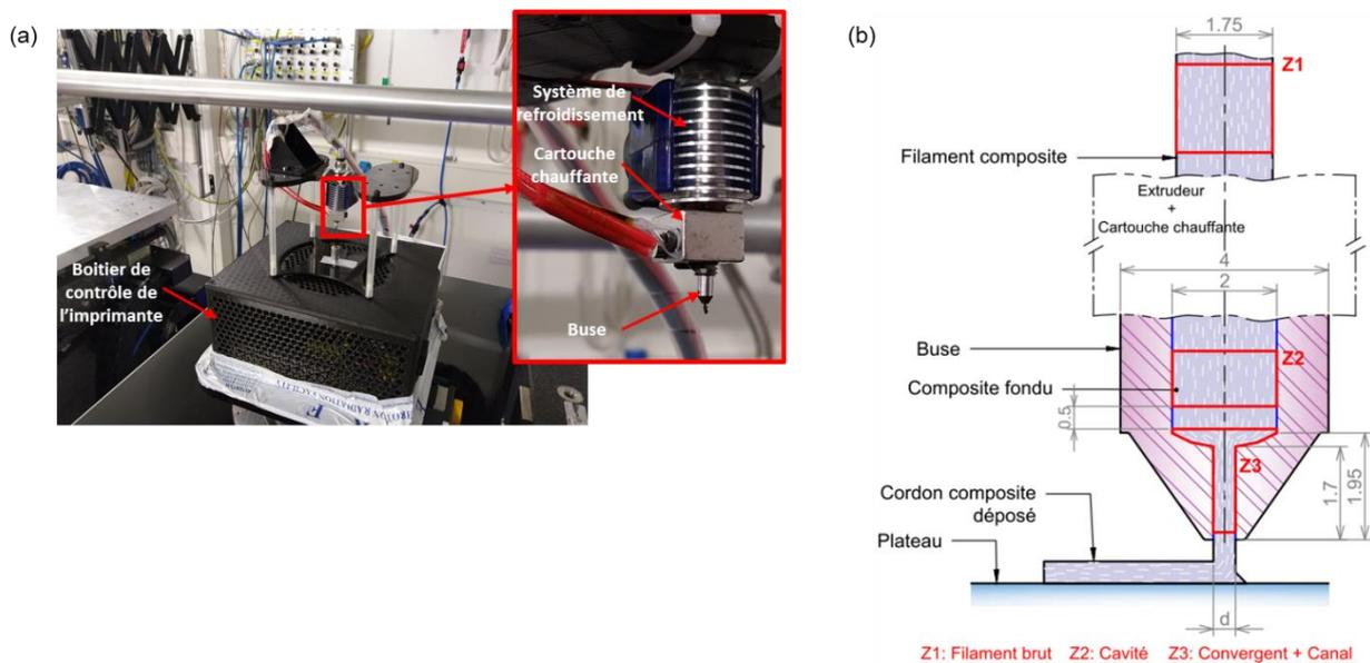
Fig. 2. (a) Dispositif d'impression 3D spécifiquement conçu pour réaliser les essais in situ par microtomographie à rayons X sur la ligne de lumière BM05 de l'ESRF (Grenoble, France). (b) Schéma d'une partie du dispositif réalisé montrant les différentes zones imagées en 3D par microtomographie à rayons X (désignées Z1, Z2 et Z3).
