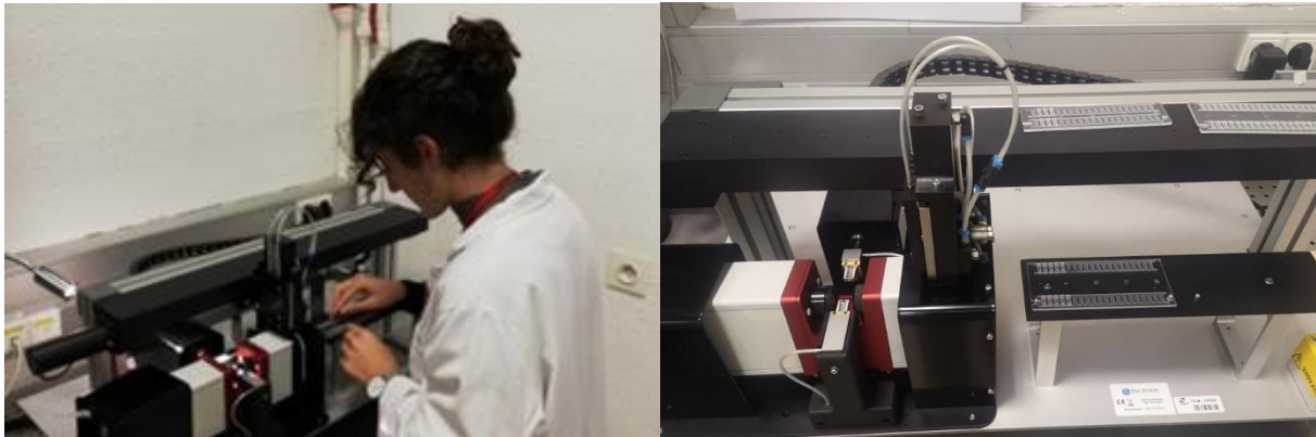
Fig. 2. Equipement Dia-Stron LDS-LEX du Centre des Matériaux. Sur l'image de droite, de gauche à droite : cellule de charge et mors du test de traction, bras pneumatique, « cassette » de préparation et stockage des échantillons mono-filamentaire
