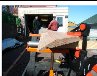
Ill. 6. Travail du biseau pour le clin de la 2e virure. © Alain Cormier, Stéphane Perrin, 2015.
