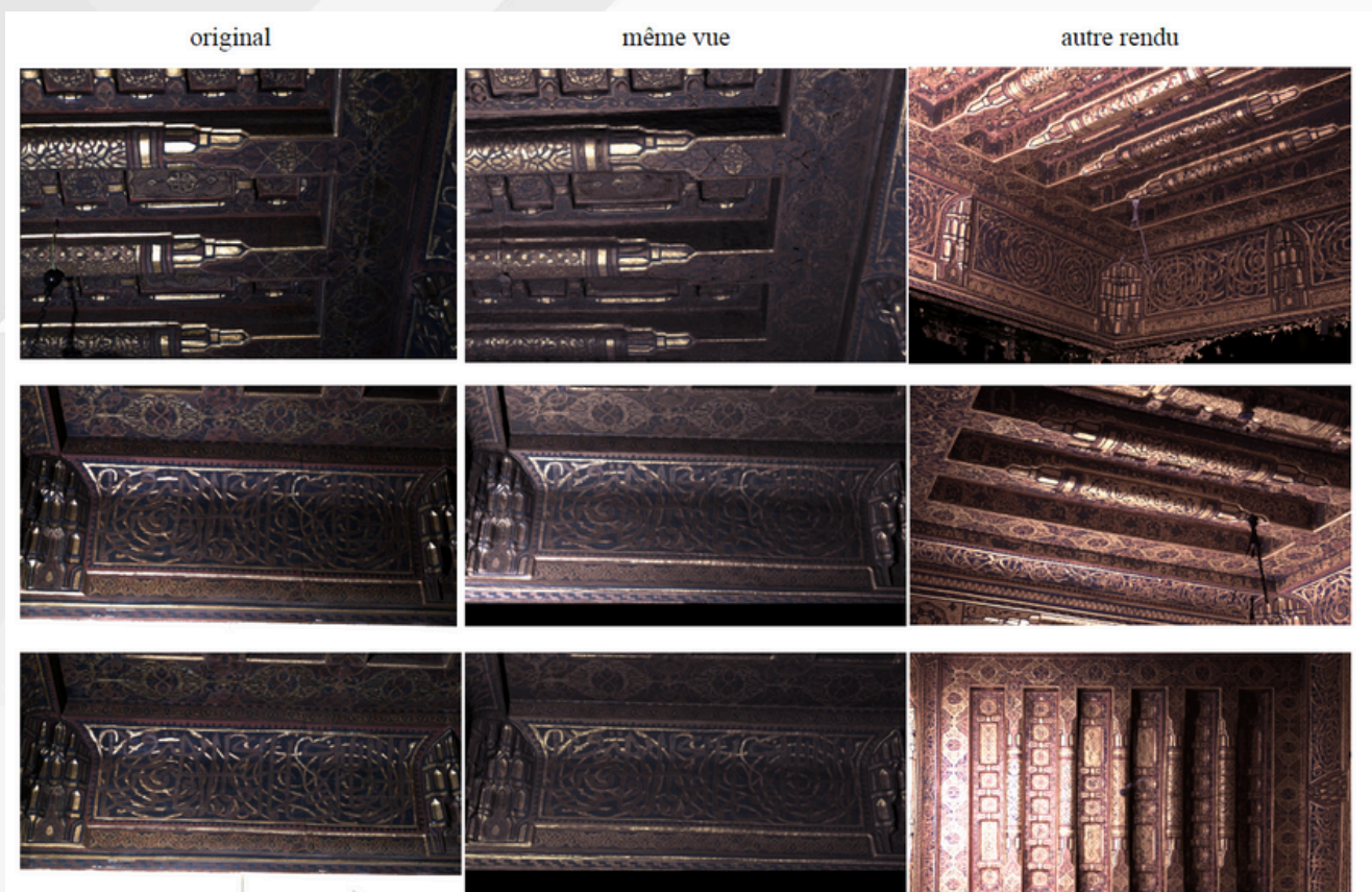
Figure 3 : Comparaison, sur un plafond de l'ambassade de France au Caire, entre les photographies d'origine (à gauche) et recalculé avec notre mesure de SVBRDF (en centre). À droite, un nouveau point de vue a été généré.
