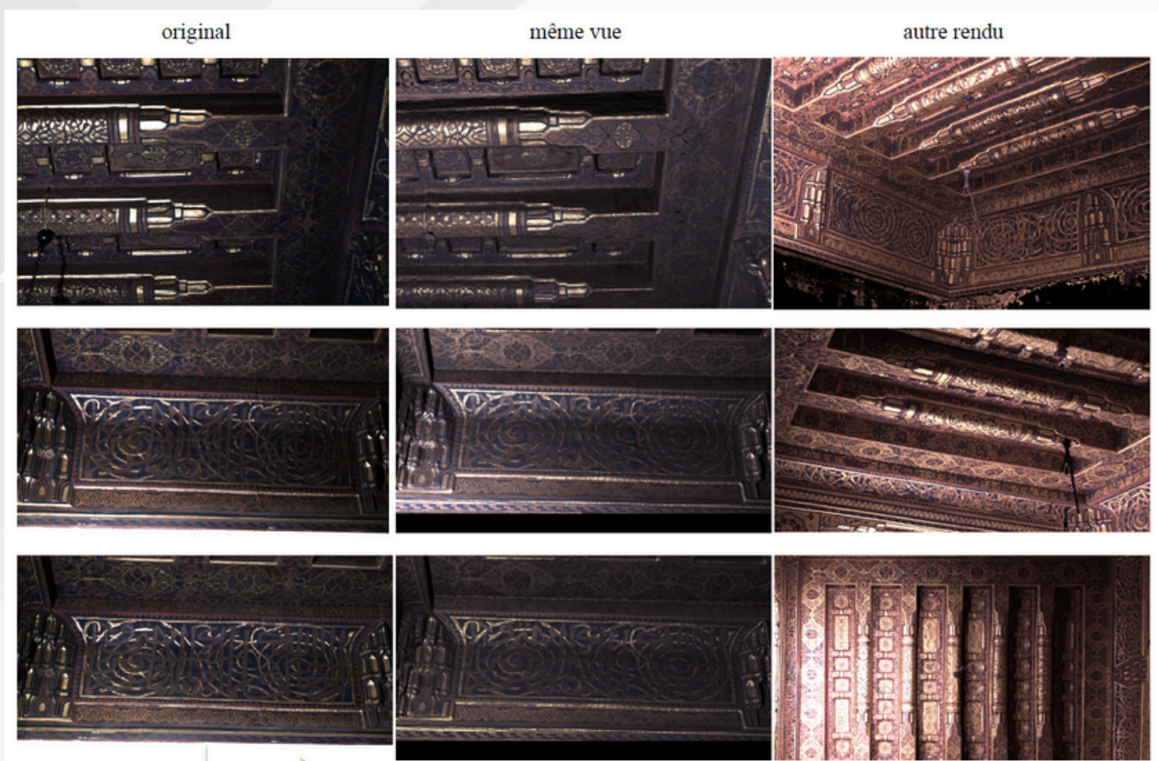
Figure 3 : Comparaison, sur un plafond de l'ambassade de France au Caire, entre les photographies d'origine (à gauche) et recalculé avec notre mesure de SVBRDF (en centre). À droite, un nouveau point de vue a été généré.
