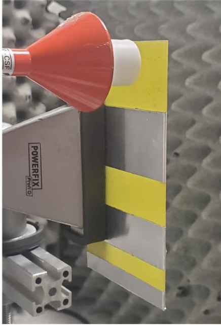
Figure 5. Banc expérimental de caractérisation d'un échantillon FR4 Epoxy constitué des parties nues et métallisées de largeur 3, 2 et 1 cm.
