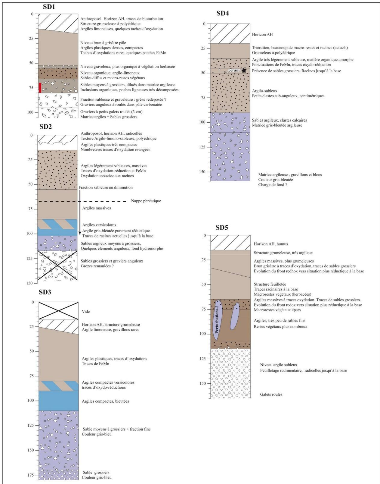
Fig. 10 : Relevés synthétiques des sondages carottés de 1 à 5
