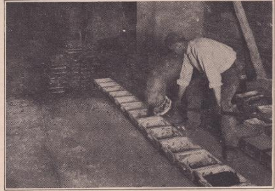
Coulée en lingotières.
