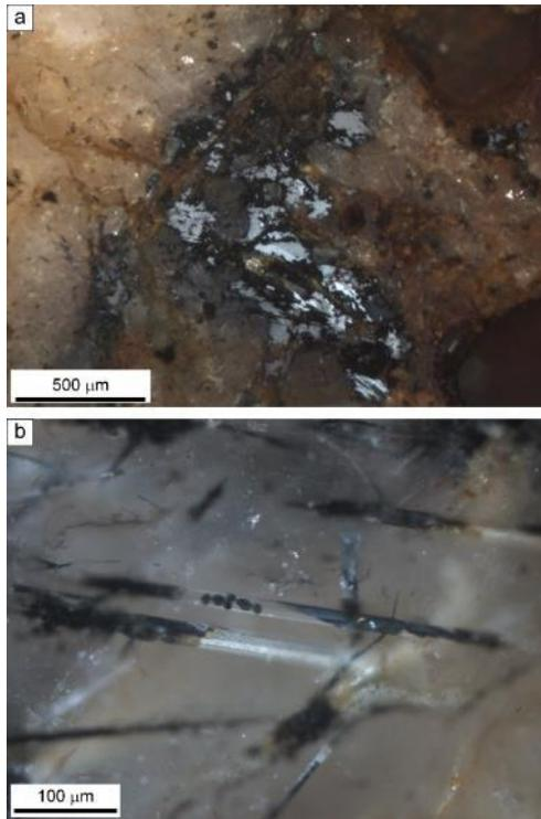
Figure 15. Le Valadou : reliques de minerai chauffé dans des pots de liquation. a : cristaux corrodés de stibine dans leur matrice quartzreuse. b : cavités laissées par la fusion de la stibine, on devine des gouttelettes dans la partie tubulaire évidée. Section polie, lumière réfléchi, polariseurs croisés.
