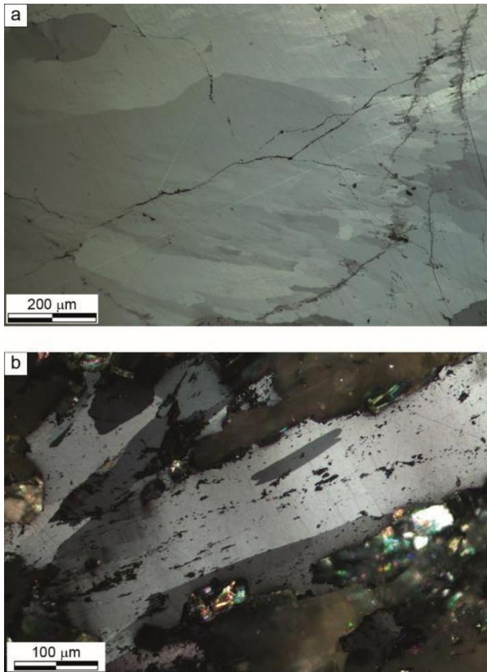
Figure 6. Microstructure de deux minerais du district de Brioude-Massiac vus en microscopie optique, lumière réfléchie, polariseurs croisés. a : la Croix-d'Astri, b : Luzer. © V. Thiéry, mars 2021.
